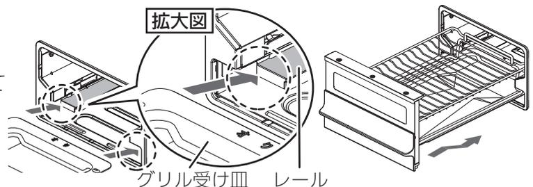
グリルとびらが閉まりにくい場合やこすれる音がした場合は、グリルとびら、グリル受け皿、グリル焼網支持台、グリル焼網が正しく取り付けられていません。そのまま押し込むと、変形や損傷の原因になりますので、再度正しく取り付け直してください。
