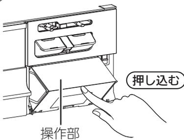
③ 操作部のふたを押し込み、操作部に取り付けてください。
