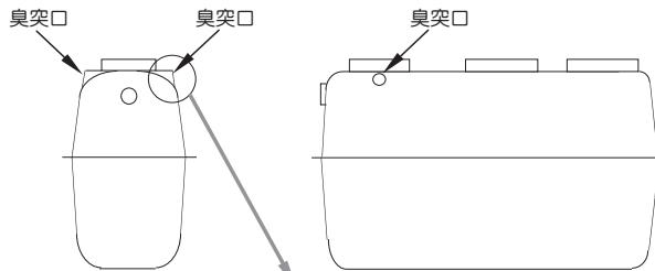
(2) パイプを槽内に30mm程度差し込み、パイプと外槽のあわせ部分全周を外側よりすき間ができるないようコーキングしてください。
