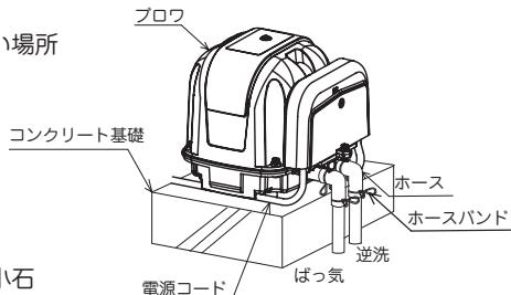
プロワと空気配管の接続は、右図のように行ってください。
