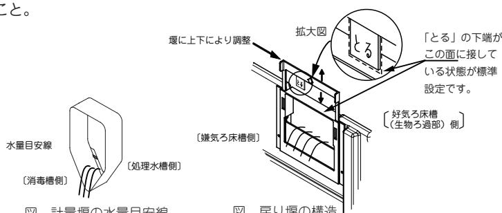
※ピークカット部の水位が低水位の場合には、移流が正しく測定できませんので、インバートマスから水道水を入れ、ピークカット部の水位を3cm程度高くしてください。
