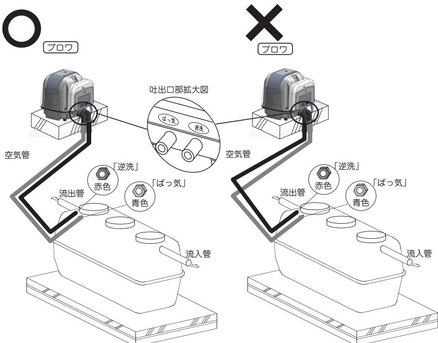
※浄化槽本体の空気口部に取付してある赤と青のキャップを配管識別用に活用してください。
