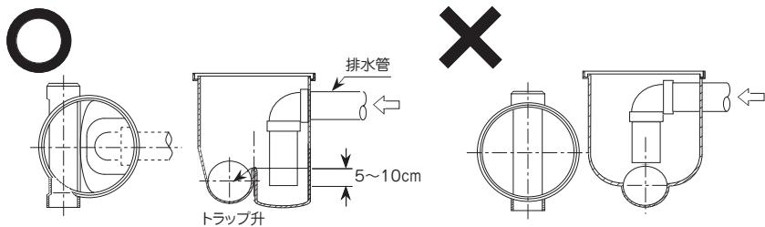
(3) 洗面台のようにトラップがある場合には、ダブルトラップにならないようにしてください。ダブルトラップになりますと排水が悪くなったり、封水切れにより臭気が侵入しやすくなります。
