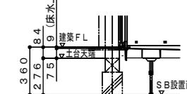
1階設置・ボルト脚 (設置高さ360mm)
