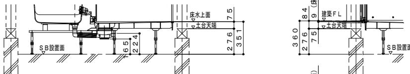
1階設置・ボルト脚 (設置高さ360mm)
