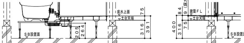
1階設置・ボルト脚 (設置高さ400mm)
