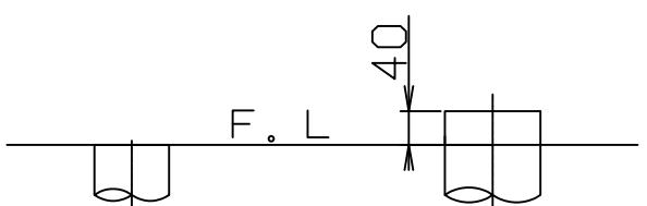
VP75の場合 床面カット VU75、VU、VP100の場合 床上40mmカット
