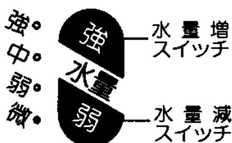
ときは<sup>※</sup>おしり洗浄スイッチまたは<sup>※</sup>ビデスイッチを押しながら水量増、減スイッチを押すと水量を微調整することができます。
