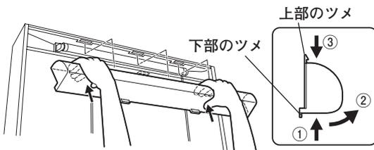
蛍光灯カバーを押し上げて、下部のツメ(2ヶ所)を外し、蛍光灯カバー下部を手前に引きながら上部のツメ(3ヶ所)を外します。
