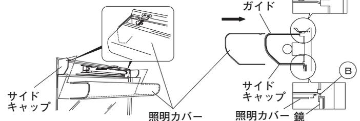
照明カバーの両端を持ち、左右のサイドキャップのガイドに沿って、照明カバーが A・B の部分に入るように上下を押さえながら差し込みます。
