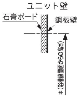
取付には、付属のφ4×16薄板用タッピンネジを6本使用します。
