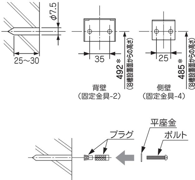
●ユニット壁（薄板鋼板壁の場合）
