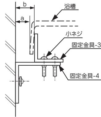
a: 浴槽と壁との隙間寸法 0～30mm
