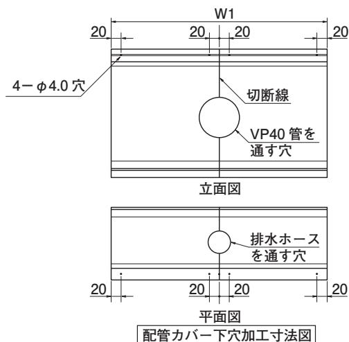
(7) 排水ホースと VP40 管を切斷した配管カバーではさむ様に設置し、配管カバーアンダーハウジング A を底板に載せ、配管カバー上端部 B を、シンクキャビネット背板の溝部に差し込んでください。配管カバーアンダーハウジング A を底板側（手前方向）へ引きよせながら、(6) で開けた下穴を使用してワークトップ同梱の固定ネジ（ $\phi 3.5 \times 13$ ）で底板に固定してください。
