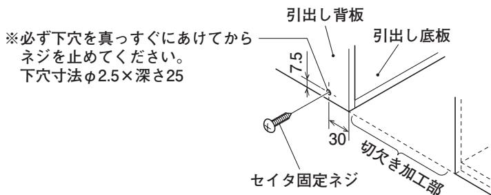
また切欠き後、左右どちらかの背板にセイタ固定ネジがなくなってしまう場合も同様に下図の位置に付属のセイタ固定ネジを打ち込んでください。
