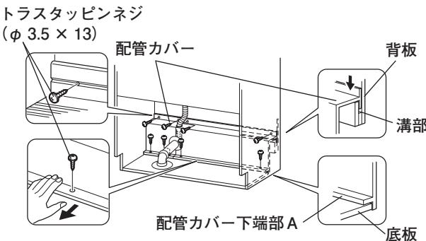
(8) 配管カバー上端部 A を (6) で開けた下穴を使用して、ワークトップ同梱の固定ネジ（ $\phi 3.5 \times 13$ ）でキャビネット背板に固定してください。（8ヶ所）
