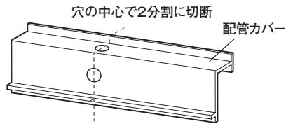
(3) 配管部材の仮組をし、寸法、組み立て、設置等、問題がないか確認してください。
