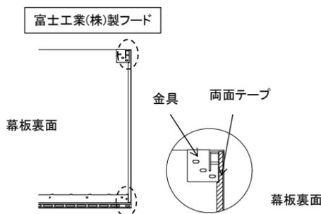
面材幕板取付金具の取付説明書に記載されている取付位置に合わせて金具を幕板裏面に仮置きし、左図の(○)部分(左右各2カ所、計4箇所)ついて、両面テープとの重なり具合を確認します。
