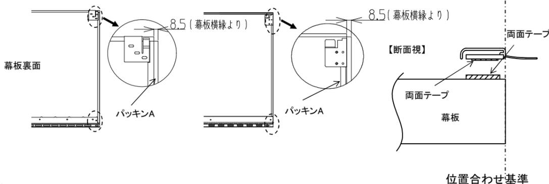
幕板に同梱されているパッキンAを幕板の端に沿って位置合わせをしてください。(左図【断面視図】を参照)このとき、パッキンの両面テープはまだ剥がさないでください。
