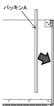
パッキンの切欠きが完了したら、パッキンを幕板に貼り付けます。
