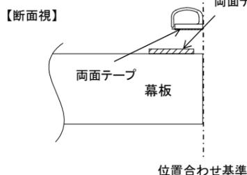
幕板に同梱されているパッキンBを幕板の端に沿って位置合わせをしてください。(左図【断面視図】を参照)このとき、パッキンの両面テープはまだ剥がさないでください。
