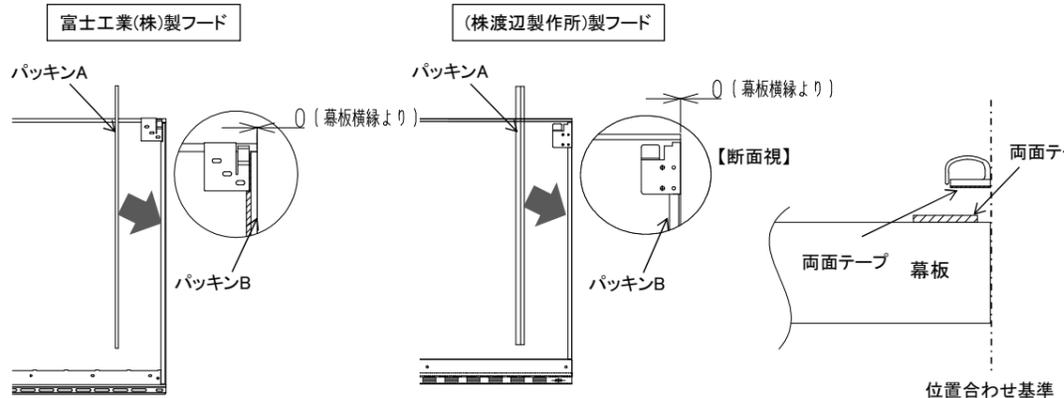
幕板に同梱されているパッキンBを幕板の端に沿って位置合わせをしてください。(左図【断面視図】を参照)このとき、パッキンの両面テープはまだ剥がさないでください。
