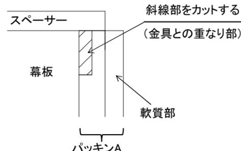
パッキンの切欠きが完了したら、パッキンを幕板に貼り付けます。
