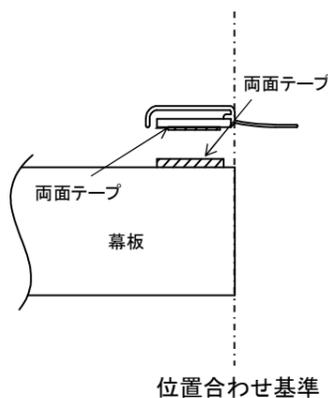
幕板に同梱されているパッキンAを幕板の端に沿って位置合わせをしてください。(左図【断面視図】を参照)このとき、パッキンの両面テープはまだ剥がさないでください。
