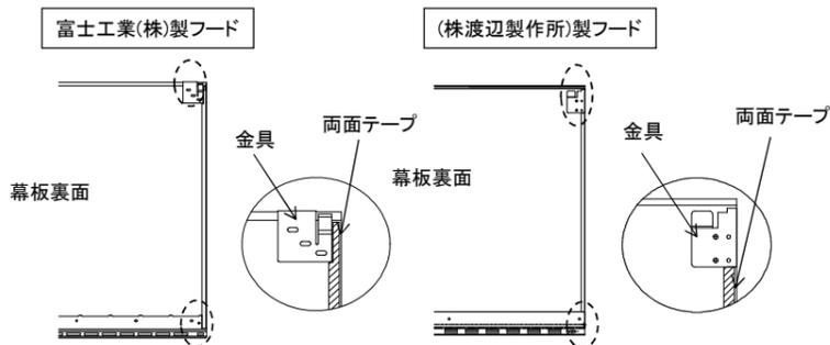
面材幕板取付金具の取付説明書に記載されている取付位置に合わせて金具を幕板裏面に仮置きし、左図の(○)部分(左右各2カ所、計4箇所)について、両面テープとの重なり具合を確認します。
