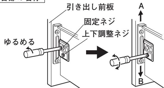
※上下調整ネジは左右両方の引き出しレールについています。
