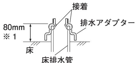
※1 の立上げ寸法については、製品の高さにより変更してください。最小で 60mm 確保してください。
