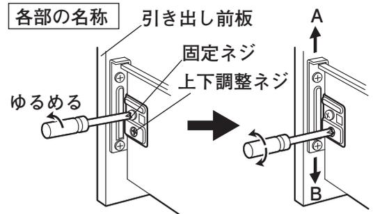
※上下調整ネジは左右両方の引き出しレールについています。
