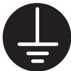
ミニキッチンユニット本体および組込み機器のアースを確実に取り付け専用の漏電遮断器を設置する。故障や漏電のときに感電する恐れがあります。アースの取り付けは、販売店にご依頼ください。ガス管への接続は、絶対にしないでください。
