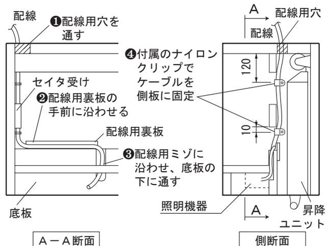
点検セイタを⑦ページで外した時の逆の手順で取り付け
