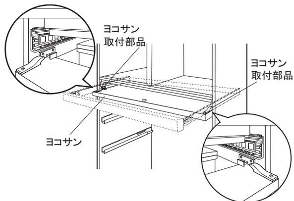
② プラスワンカウンターの前板中央付近を押すと、ロックが解除されプラスワンカウンターが少し出てきます。その後前板をつかんで引出してください。
