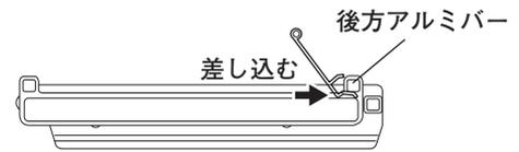
②落下防止部材の根本をしっかりとアルミバーに押し当てながら、アルミバーを軸として回転させるようにして上端部をどこでもパレット後方へ向かって押し上げて落下防止部材を固定して下さい。
