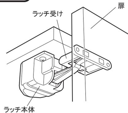
キャビネットを壁面取り付け後、クリップ下部のつまみを持ち、手前上方に引き上げるようにして取り外してください。
