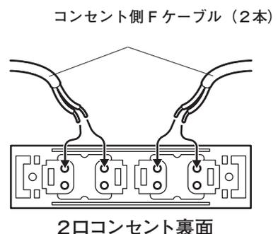
※コンセント及び蒸気排出ユニットに結線するためのFケーブルの被覆を剥ぐ長さが異なりますのでご注意ください。
