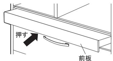
③ プラスワンカウンターのレール側面にある脱着レバーを手前側に左右同時に動かした状態でカウンターを引っ張り取り外してください。
