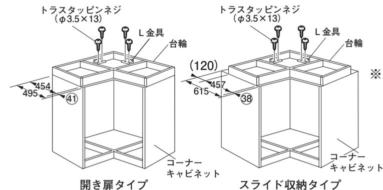
※台輪の取り付け位置はキャビネットタイプにより異なります。必ず○印の寸法に従い、台輪を取り付けてください。取付寸法がずれると、隣接するキャビネットとの木口面が合わなくなります。
