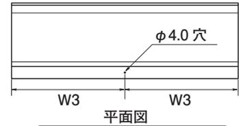
配管カバー下穴加工寸法図
