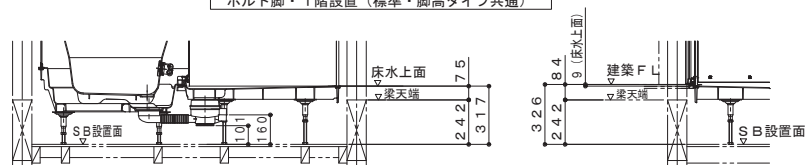
ボルト脚・階上設置（設置高さ326mm）
