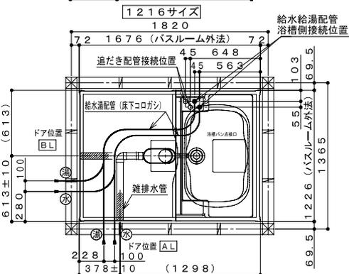
※給水湯配管の方向はドア位置に合わせて現地加工（曲げ）となります。
