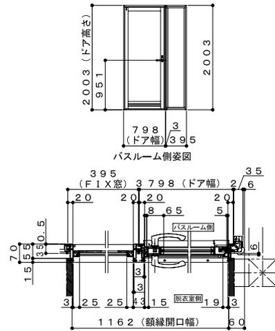
※印の寸法は木造軸組構造の標準的な寸法です。建築構造によっては異なる場合がありますのでよくご確認ください。
