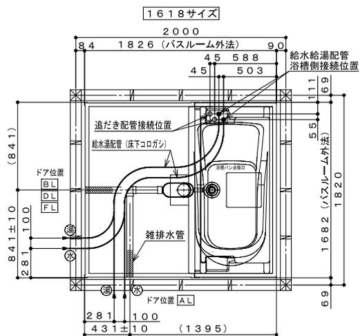
※給水湯配管の方向はドア位置に合わせて現地加工（曲げ）となります。
