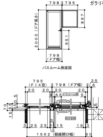
※印の寸法は木造軸組構造の標準的な寸法です。建築構造によっては異なる場合がありますのでよくご確認ください。
