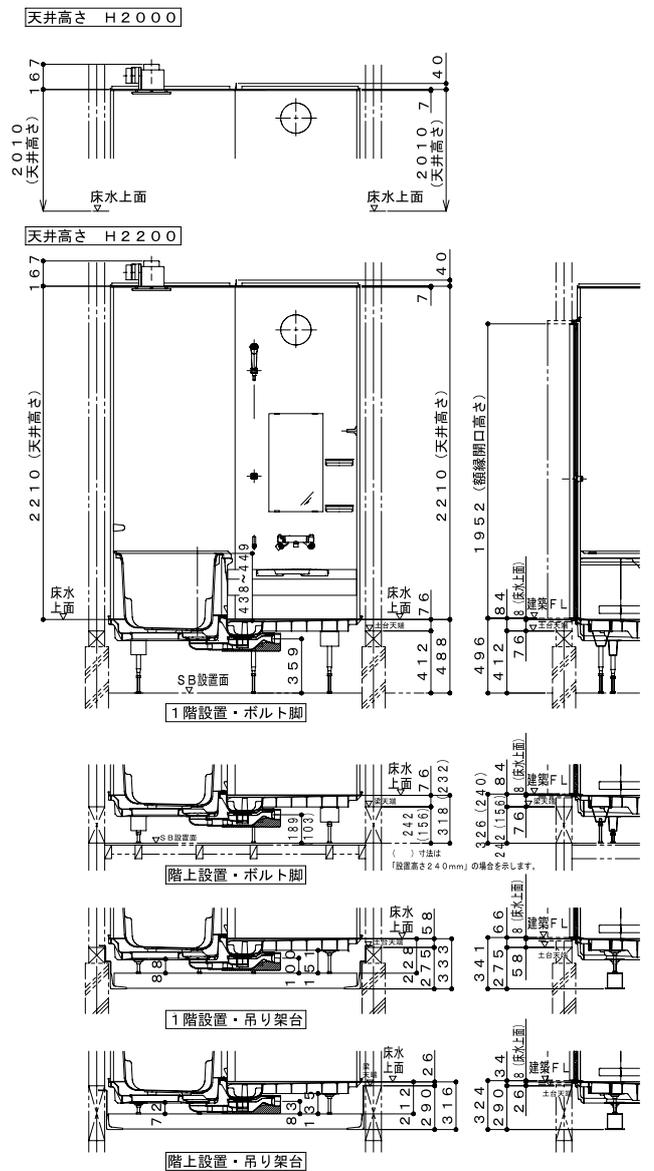
※1. 浴槽またぎ寸法は床(洗い場)に勾配があるため、最小(壁側)から最大(中央)の寸法で表示しています。
