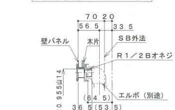
給水給湯ジョイント部
