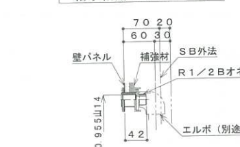
給水給湯ジョイント部
