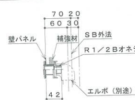
給水給湯ジョイント部
