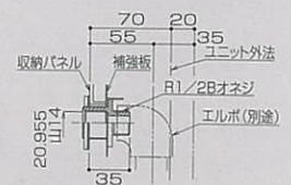
収納パネル取付洗場水栓部 給水・給湯ジョイント
