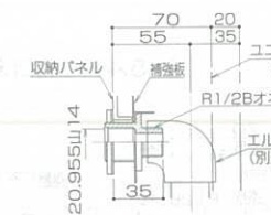
収納パネル取付洗場水栓部 給水・給湯ジョイント
