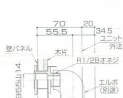
浴槽水栓・共用排水栓部 給水・給湯ジョイント
