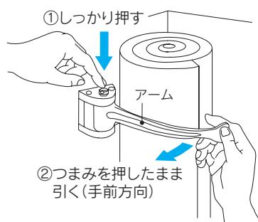
つまみを押さずに手前方向にアームを引くと破損の原因となりますので絶対に行わないで下さい。
