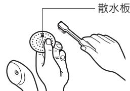
①ねじがあるものは、ねじをゆるめて散水板を外します。またねじがないものは、散水板そのものをまわして外します。
