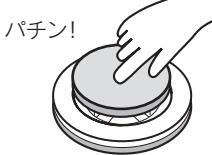
取り付けは軸を下げる状態でパチンと音がするまで押し込んでください。
