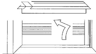
(3) 取付は、逆の手順で行います。排水溝のカバーは板バネにカチッと音がするまで、確実に押し込んでください。排水溝のカバーをはずした状態でご使用になりますと、床に流れた水が外に出るおそれがあります。また、ツマミは必ずおろしてください。
