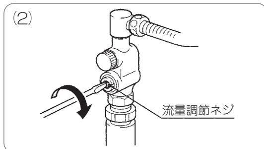
ストレーナ止水栓の流量調節ネジを⊖ドライバーで右にいっぱいまで回して締め込み、湯・水を完全に止めてください。
