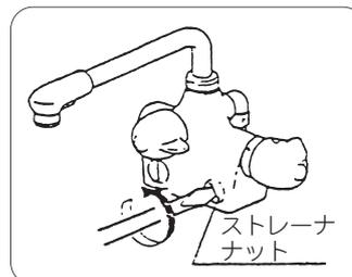
ストレーナ（逆止弁付）を大型の⊖ドライバーで左に回してはずします。（上図は水側の場合）
