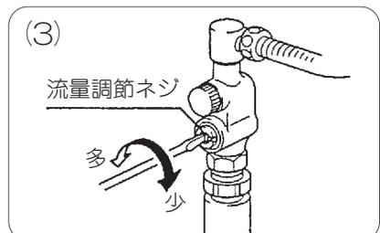
(3) 流量調節ネジを右に回すと流量が少なくなり、左に回すと多くなりますので湯側の太さと同程度になるよう水側を調節してください。
