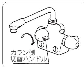
切替ハンドルを右側に回し、吐水状態にします。元栓を、右いっぱいまで回して締め込み、湯・水を完全に止めます。
