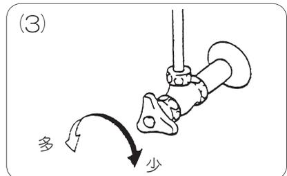
(3) 止水栓を右に回すと流量が少なくなり、左に回すと多くなりますので湯側の太さと同程度になるよう水側を調節してください。
