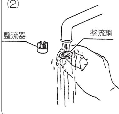
整流網と整流器をよく水洗いし、砂・ゴミなどを完全に除去してください。
