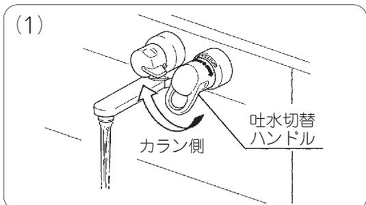
吐水切替ハンドルを左方向に回し、吐水状態にしてください。
