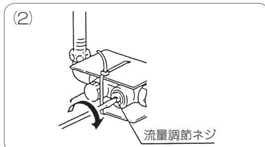
逆止ボックスの流量調節ネジ⊖ドライバーで右にいっぱいまで回して締め込み、湯・水を完全に止めてください。
