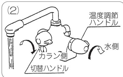
(2) 切替ハンドルを吐水パイプ側全開にした後、温度調節ハンドルを水側いっぱい回して、吐水の太さを確認してください。
