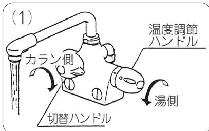
(1) 切替ハンドルを吐水パイプ側全開にした後、温度調節ハンドルを湯側いっぱい回して、吐水の太さを確認してください。
