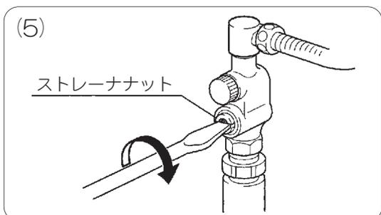
ストレーナをストレーナナットにはめ、ストレーナ止水栓にねじ込んでください。ねじ込む際、ストレーナナットが回らなくなるまで、確実にねじ込んでください。
