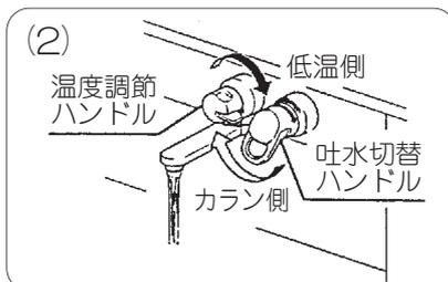
(2) 切替ハンドルをカラン側全開にした後、温度調節ハンドルを低温側いっぱい回して、吐水の太さを確認してください。
