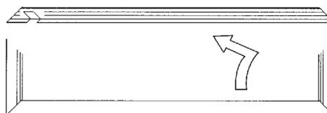
(6) 取付は、逆の手順で行います。レールを下枠凹部に引っかけ、板バネにカチッと音がするまで確実に押し込んでください。また、ツマミは必ずおろしてください。
