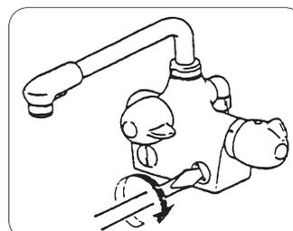
ストレーナ（逆止弁付）を器具の本体にねじ込みます。ねじ込む際、ストレーナナットが回らなくなるまで、確実にねじ込んでください。
