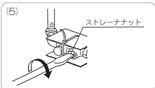
ストレーナをストレーナナットにはめ、逆止ボックスにねじ込んでください。ねじ込む際、ストレーナナットが回らなくなるまで、確実にねじ込んでください。
