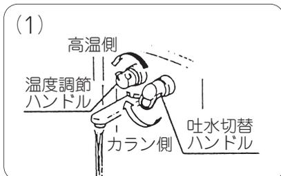
(1) 切替ハンドルをカラン側全開にした後、温度調節ハンドルを高温側いっぱい回して、吐水の太さを確認してください。
