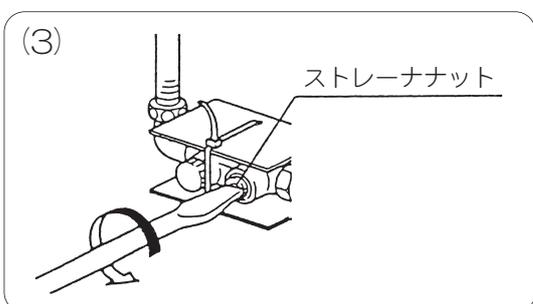
ストレーナナットを大型の⊖ドライバーで左に回してはずしてください。
