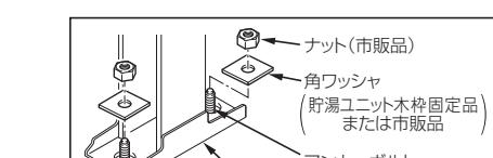
壁固定金具(1個付属)※壁面等に固定する
