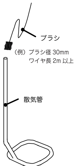
図 散気管・逆洗管の概略図
