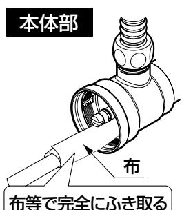
フィルターの掃除を行っても湯量が増えない場合は、11 ページの「機器内の水抜き」に従って、水を抜いた後に、ストレーナーの掃除を行ってください。
