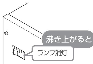
タンク内の湯の温度が下がると再び沸き上げを開始する
