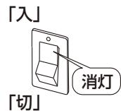
タンク内の水がわきあがると、ヒーターの通電を停止するためスイッチ部が消灯します。
