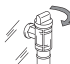
〔ガス元栓の例〕
