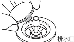
③排水口フタを外して軸部を左回し(反時計回し)に回転させてコイル状ワイヤーの圧縮を解いてください。
