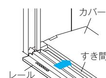
下枠カバーを外した状態で使用すると水漏れの原因になりますので必ず確実に取り付けてください。
