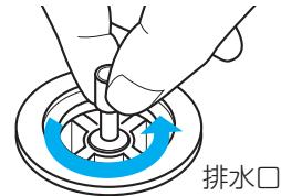
④排水栓を作動させ押しボタン部が上がつたことを確認してください。
