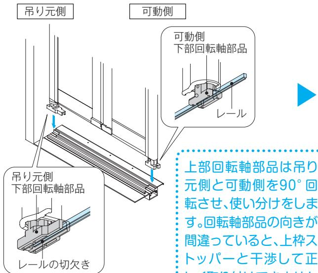
上部回転軸部品は吊り元側と可動側を90°回転させ、使い分けをします。回転軸部品の向きが間違っていると、上枠トップバーと干渉して正しく取り付けできません。
