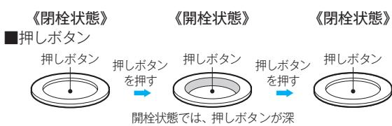
開栓状態では、押しボタンが深く下がった状態となり、内部側面部分がはっきりと見えます。
