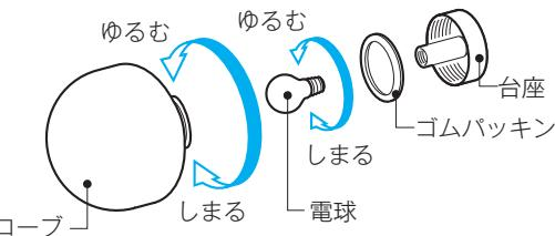
取付の際は、ゴムパッキンを忘れずに入れてください。しめすぎ・ゆるめすぎのないよう気を付けてください。方向のあるグローブの場合は、水平になるように取り付けてください。
