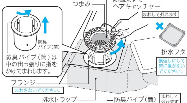
お掃除が終わったら、防臭パイプ(筒)やヘアキャッチャー、排水フタを正しく取り付けてください。その後、トラップ内に封水をためるために洗面器1杯くらいの水を流してください。
