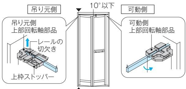
⑤ドア取り付け後、各回転軸部品の向きを確認してください。
