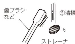
清掃後は逆の手順でストレーナ・整流器キャップを取付けてください。
