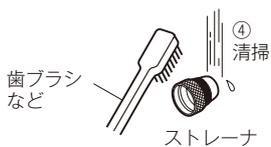
清掃後は逆の手順でストレーナ・ソケットを取付けてください。また、ストレーナを締め込むときは湯水切換ハンドルを吐水口側にしてください。
