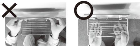
傾いた場合は、壁に吸着させたままずらすず、いったん壁から外して再度付け直してください。
