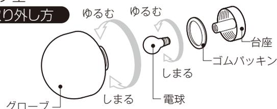
取付の際は、ゴムパッキンを忘れずに入れてください。しめすぎ・ゆるめすぎのないよう気を付けてください。方向のあるグローブの場合は、水平になるように取り付けてください。
