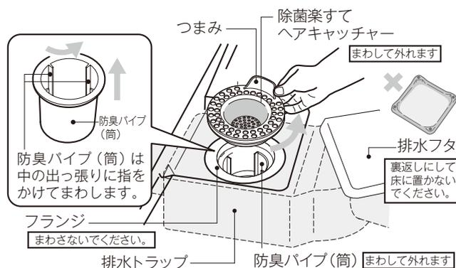
お掃除が終わったら、防臭パイプ(筒)やヘアキャッチャー、排水フタを正しく取り付けてください。その後、トラップ内に封水をためるために洗面器1杯くらいの水を流してください。
