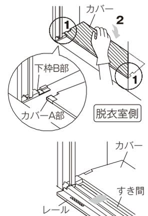
下枠カバーを外した状態で使用すると水漏れの原因になりますので必ず確実に取り付けてください。
