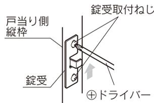
ロックつまみ(大)の下面とロック受けの切り欠き下のラインが同じ高さになるように、ロック受けの位置を調整してください。
