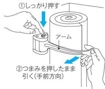
つまみを押さずに手前方向にアームを引くと破損の原因となりますので絶対に行わないでください。
