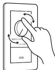
スイッチのON/OFF操作により2段階の調色(電球色⇄昼白色)、ボリュームつまみを操作して無段階調光ができます。
