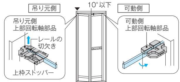
⑤ドア取り付け後、各回転軸部品の向きを確認してください。
