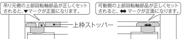
ドアを取り付けた後は必ず開閉動作の確認をしてください。
