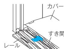
下枠カバーを外した状態で使用すると水漏れの原因となりますので必ず確実に取り付けてください。
