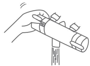
表示通りの温度でお湯が出ないときは専用の取扱説明書に記載されている調整方法をお試しください。
