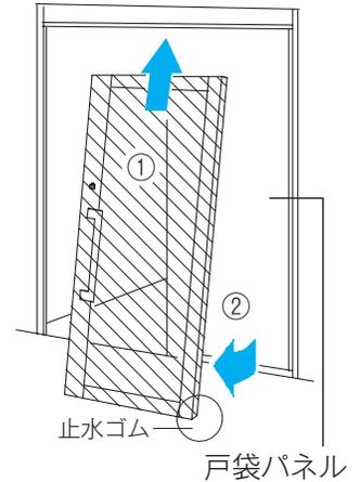
外したドアは止水ゴムをいためないよう静かに置き、置いた状態では引きずらないでください。
