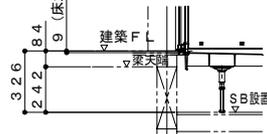
ボルト脚・階上設置（設置高さ326mm）
