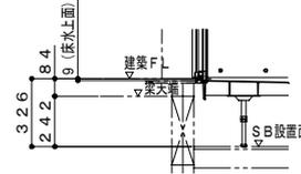
ボルト脚・階上設置 (設置高さ326mm)
