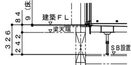
ボルト脚・階上設置（設置高さ326mm）
