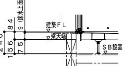
ボルト脚・階上設置（設置高さ240mm）
