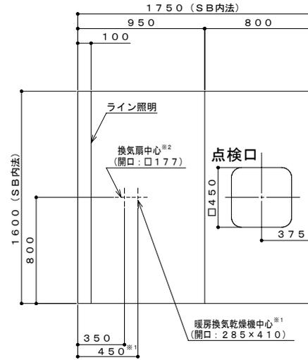
※設置必要最小寸法は仕様により異なり、本図は壁断熱なしで表示しています。他の仕様については寸法・データ表で確認ください。
