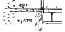
吊り架台・1階設置
