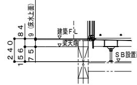
ボルト脚・階上設置 (設置高さ240mm)
