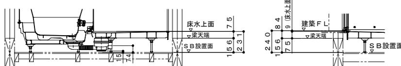
ボルト脚・階上設置（設置高さ240mm）
