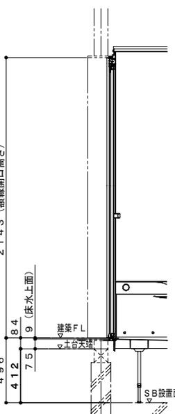
ボルト脚・1階設置（標準・脚高タイプ共通）
