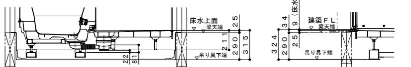
吊り架台・階上設置
