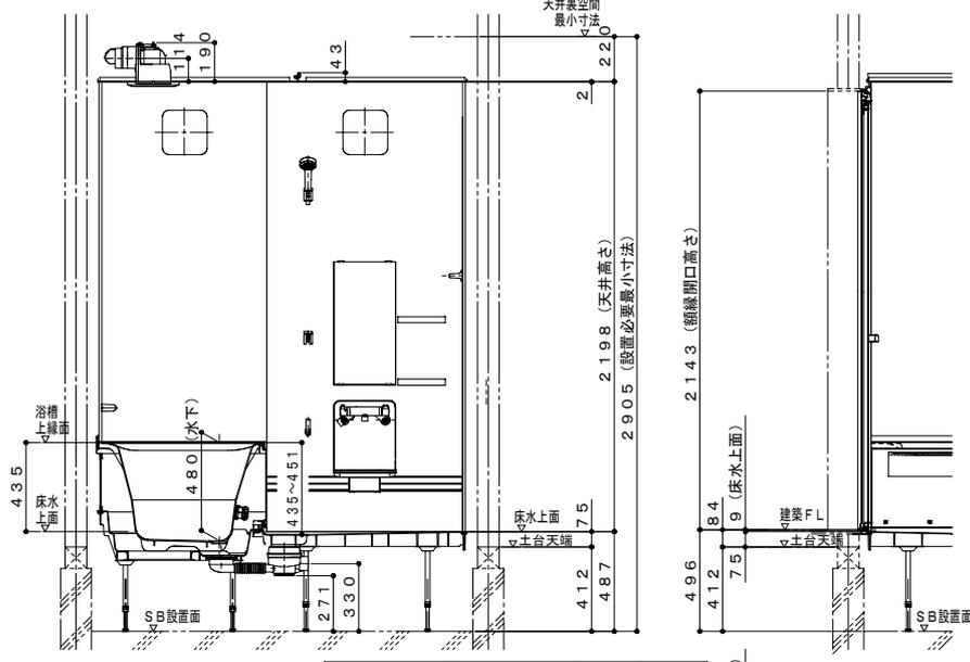
ボルト脚・1階設置 (標準・脚高タイプ共通)
