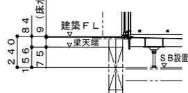
ボルト脚・階上設置（設置高さ240mm）
