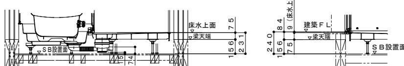
ボルト脚・階上設置 (設置高さ240mm)
