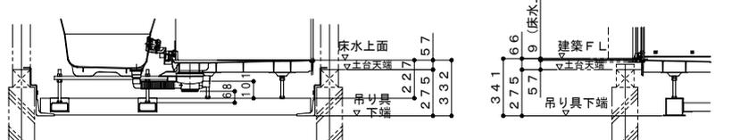
吊り架台・1階設置
