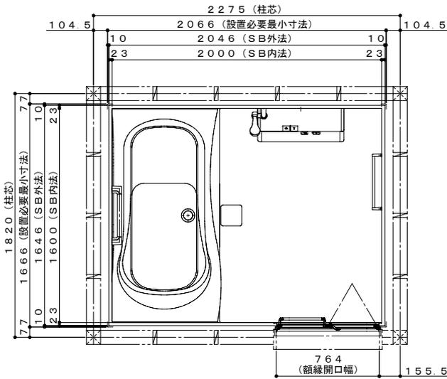
※設置必要最小寸法は仕様により異なり、本図は壁断熱なしで表示しています。他の仕様については寸法・データ表で確認ください。
