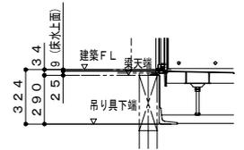
吊り架台・階上設置
