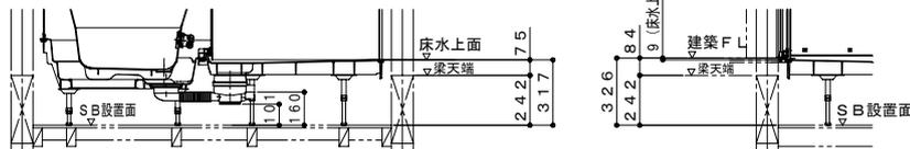
ボルト脚・階上設置（設置高さ326mm）
