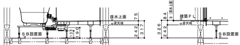
ボルト脚・階上設置 (設置高さ326mm)
