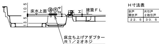
給水給湯接続位置・雑排水管取出位置
