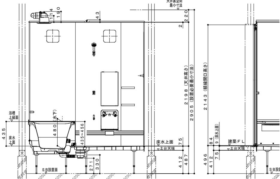
ボルト脚・1階設置 (標準・脚高タイプ共通)
