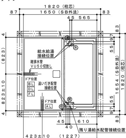
給水給湯接続位置・雑排水管取出位置
