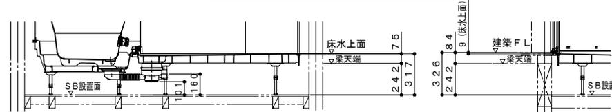
ボルト脚・階上設置 (設置高さ326mm)
