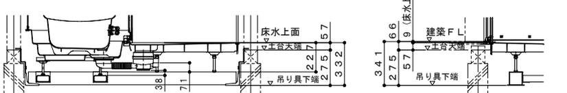
吊り架台・1階設置
