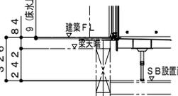
ボルト脚・階上設置（設置高さ326mm）
