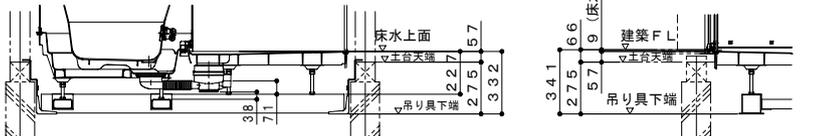
吊り架台・1階設置
