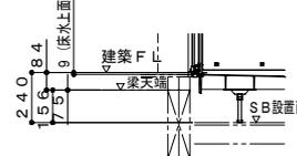
ボルト脚・階上設置 (設置高さ240mm)
