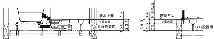
ボルト脚・階上設置 (設置高さ240mm)
