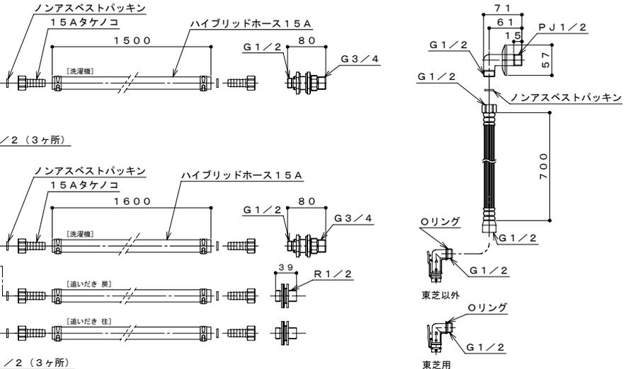
追いだき配管セット (洗濯用残り湯給水システム用)
