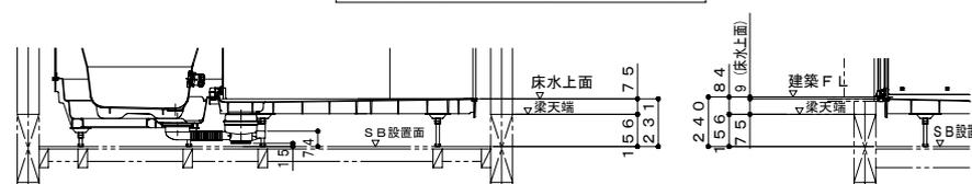
ボルト脚・階上設置 (設置高さ240mm)
