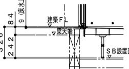
ボルト脚・階上設置（設置高さ326mm）
