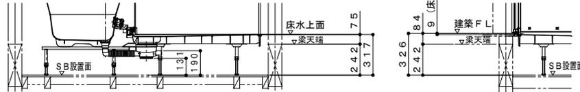
ボルト脚・階上設置 (設置高さ326mm)
