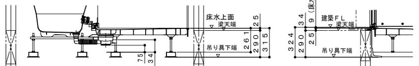
吊り架台・階上設置
