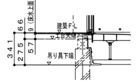
吊り架台・1階設置
