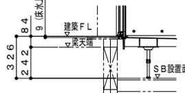
ボルト脚・階上設置（設置高さ326mm）
