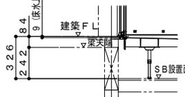
ボルト脚・階上設置 (設置高さ326mm)
