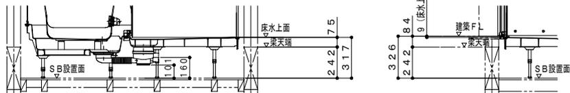
ボルト脚・階上設置（設置高さ326mm）
