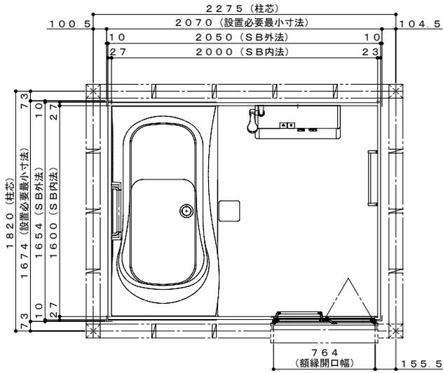
※設置必要最小寸法は仕様により異なり、本図は壁断熱なしで表示しています。
