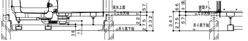
吊り架台・1階設置
