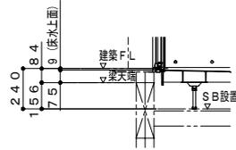
ボルト脚・階上設置（設置高さ240mm）
