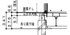
吊り架台・1階設置
