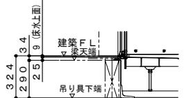
吊り架台・階上設置
