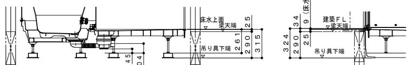
吊り架台・階上設置
