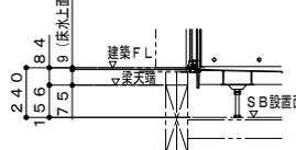
ボルト脚・階上設置（設置高さ240mm）
