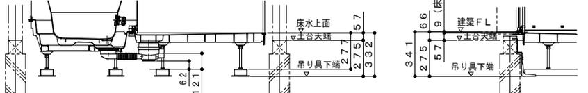
吊り架台・1階設置
