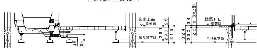
吊り架台・階上設置
