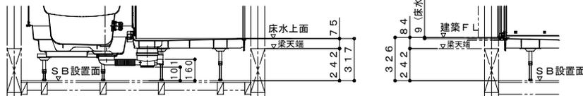
ボルト脚・階上設置 (設置高さ326mm)
