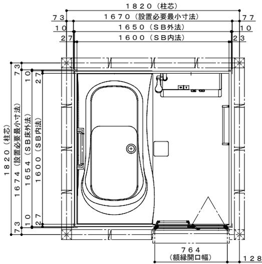
※設置必要最小寸法は仕様により異なり、本図は壁断熱なしで表示しています。他の仕様については寸法・データ表で確認ください。
