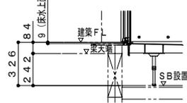
ボルト脚・階上設置（設置高さ326mm）
