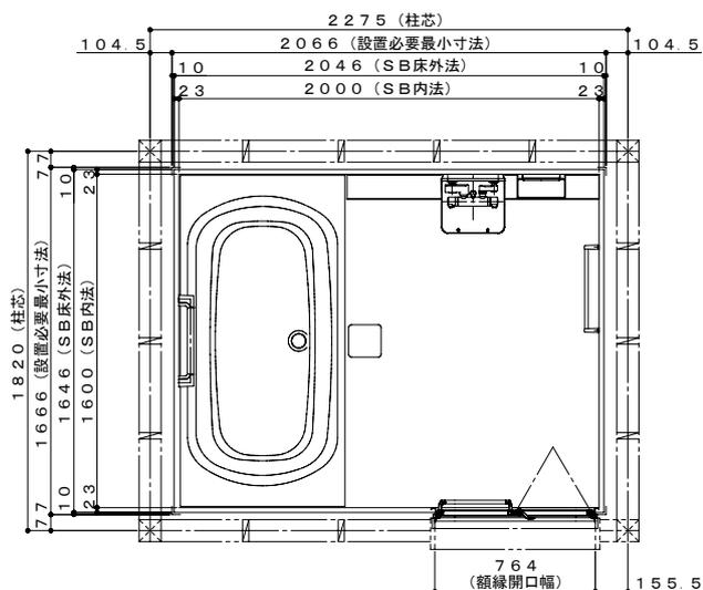
※設置必要最小寸法は仕様により異なり、本図は壁断熱なしで表示しています。他の仕様については寸法・データ表で確認ください。
