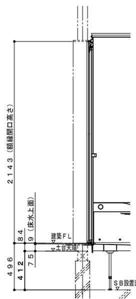
ボルト脚・1階設置 (標準・脚高タイプ共通)
