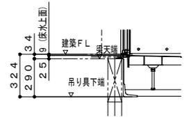
吊り架台・階上設置
