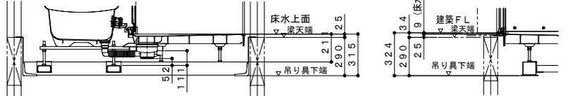
吊り架台・階上設置
